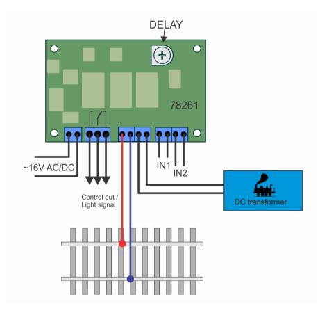
Abbildung 2: Anschluss der Steuerungseingänge an den beiden Anschlusspunkten
